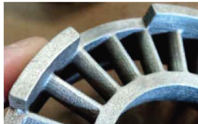
Аддитивная технология Износ после 600 часов.
