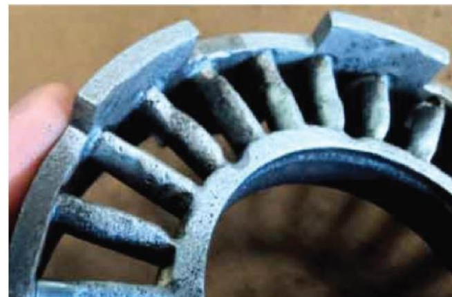
Традиционная технология Износ после 300 часов.
